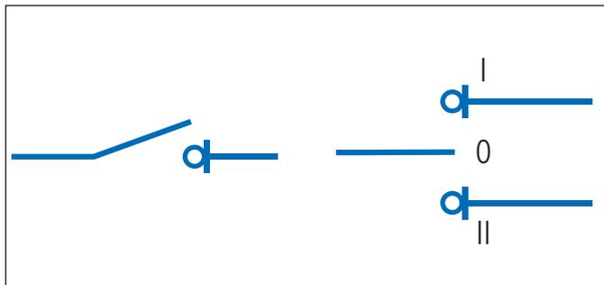
Выключатели нагрузки с предохранительными вставками
